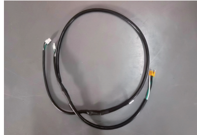
Netzwerkabel der Gehäuseabschnitte „C“, „D“ und „E“
