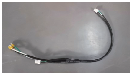
Cable de alimentación de las secciones "A" y "B" del armario
